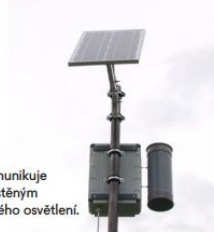
5_ Detektor zaznamená příjezd vozidla na základě změny magnetického pole.
